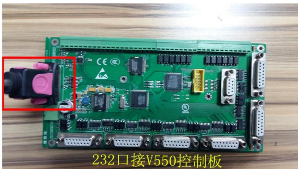
2. 如果控制板主板自带 232 接口，可使用 232 公母头直线式线缆，母头接电脑主机上的 232 接口，公头接控制板上 232 接口。
